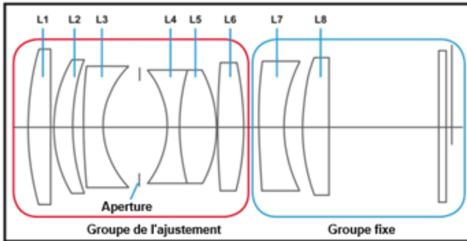
Mécanisme de mise au point flottant
